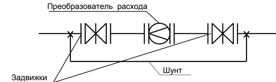
Рисунок 6.4 – Шунтирование преобразователя
