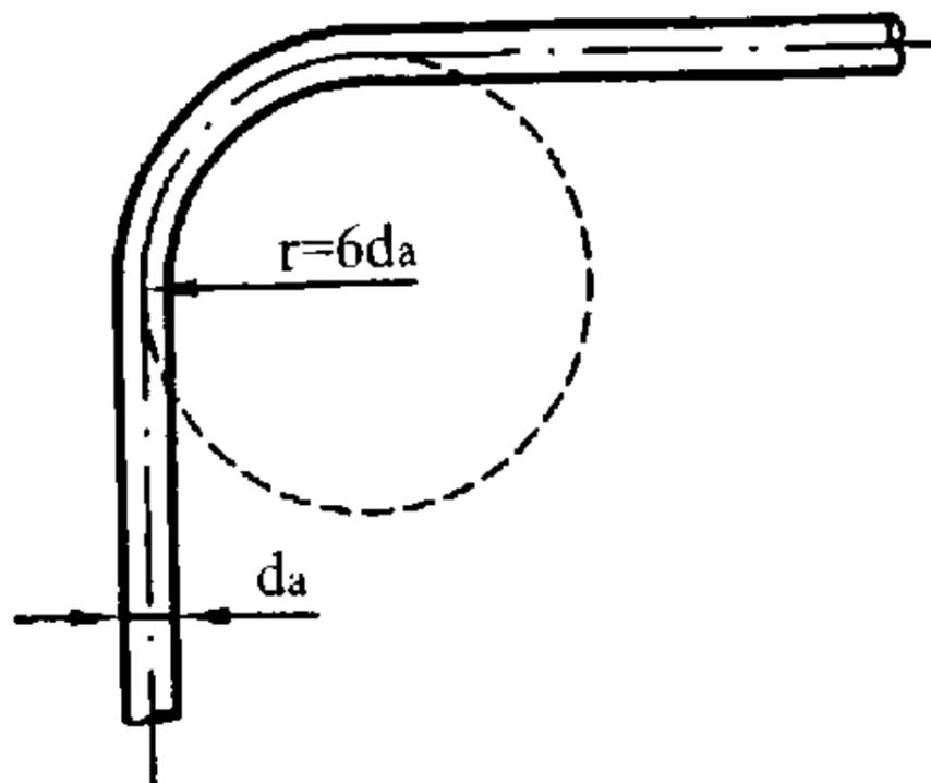
**Рисунок 13** — Холодная гибка медной трубы
