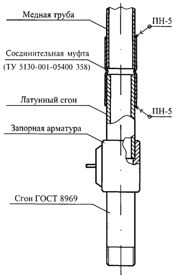
**Рисунок 6** — Присоединение запорной арматуры к медному газопроводу
