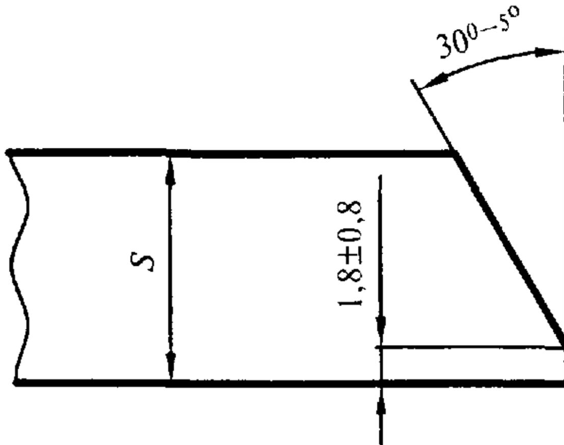
**Рисунок 9** — Схема обработки кромки
