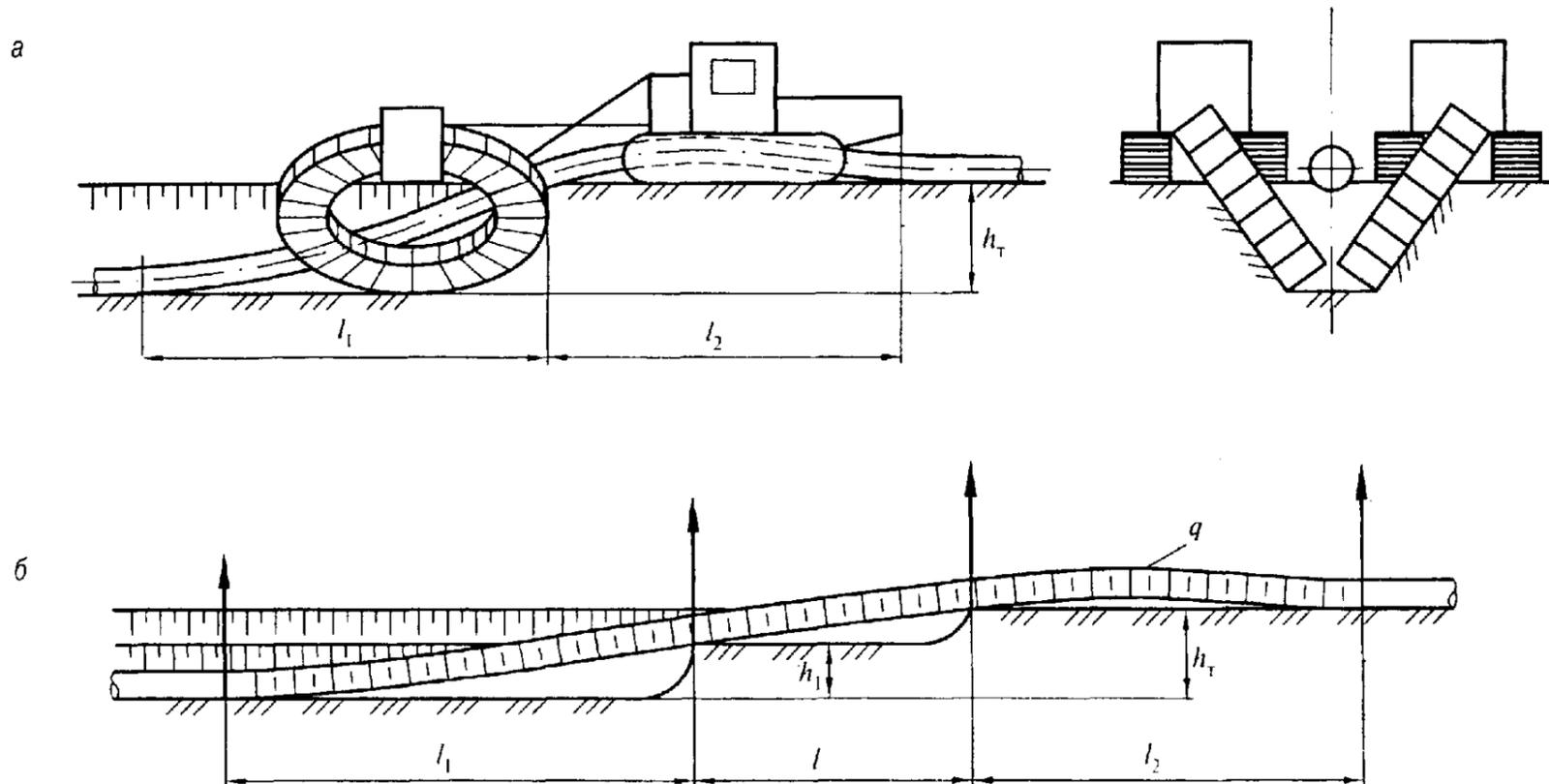
**Рисунок 23** — Укладка газопровода методом «подкопа»
