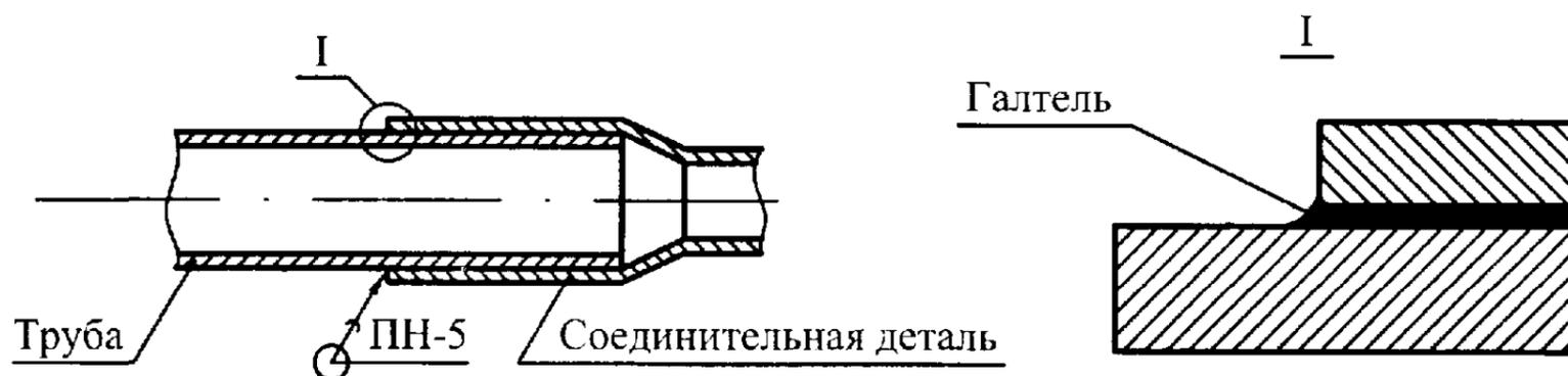
**Рисунок 16** — Схема паяного соединения
