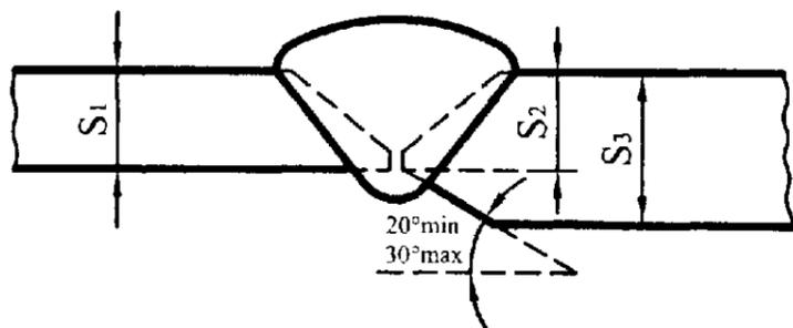
Соединение  $S_2 \leq 1,5S_1$  без обработки свариваемых торцов ( $S_2 = S_3$ )
