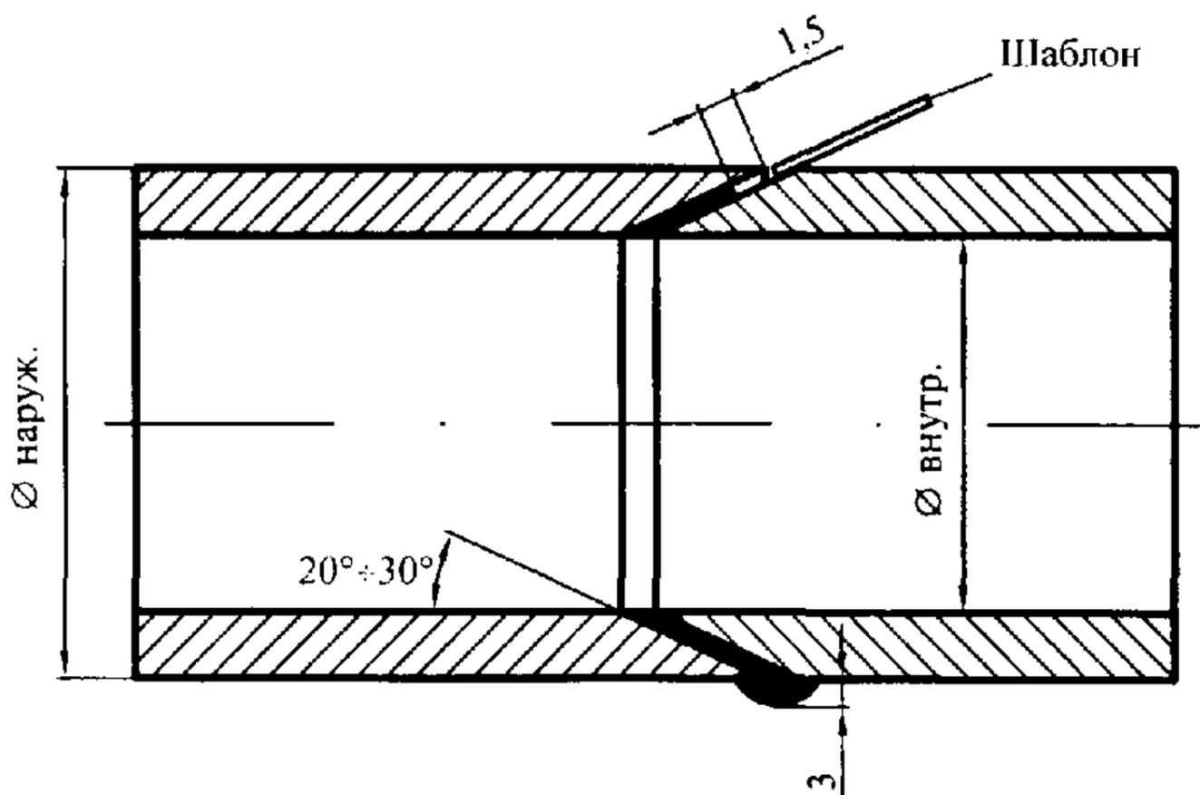
**Рисунок 11** — Паяное соединение стальных труб
