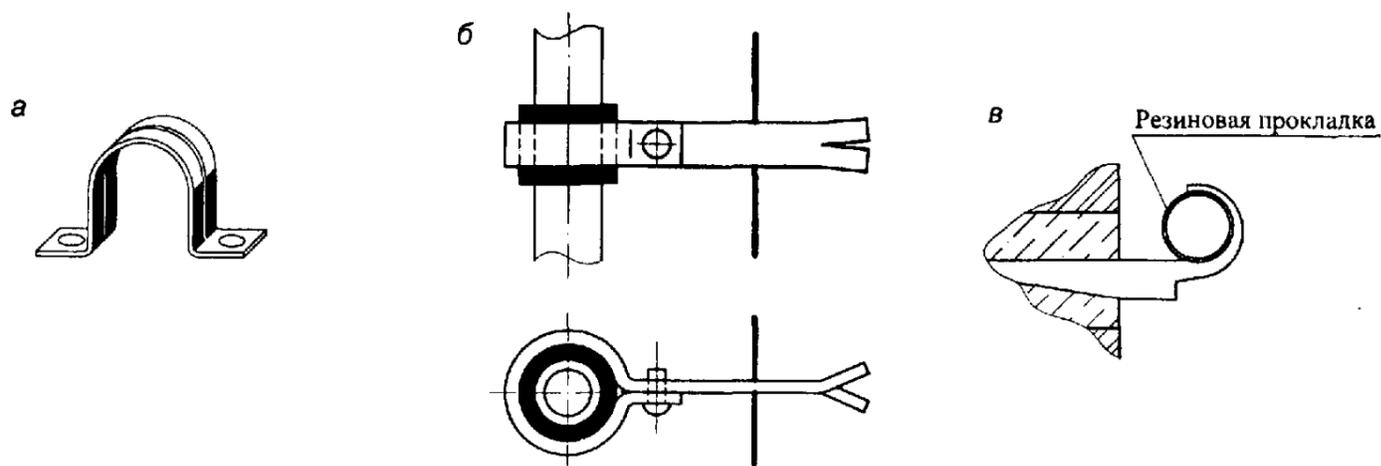
**Рисунок 5** — Опоры для крепления медных газопроводов
