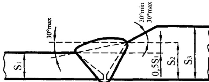
**Рисунок 10** — Обработка свариваемых торцов труб
