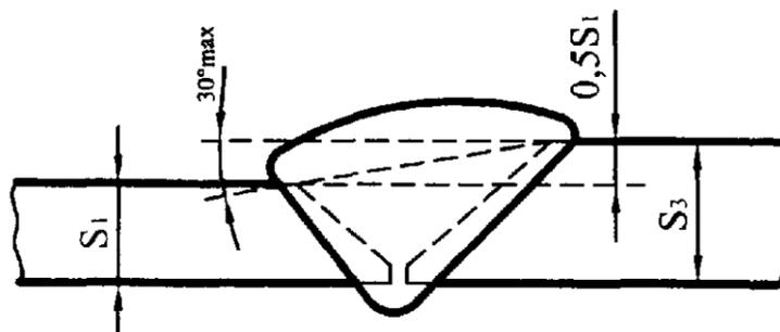
Обработка с наружной стороны толщины  $S_3$  до  $S_2 \leq 1,5S_1$
