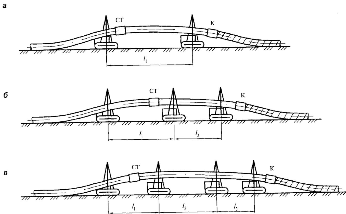
**Рисунок 18** — Схема расстановки трубоукладчиков для укладки плети газопровода при использовании комбайна для очистки и изоляции труб диаметром: а — 500 мм и менее; б — 700—1000 мм; в — 1000 —1200 мм
