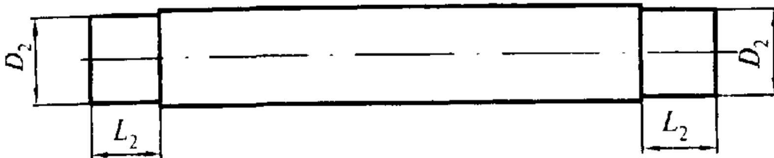
**Рисунок 15** — Схема калибровки медных труб перед монтажом
