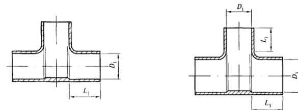
Рисунок Д.5 — Тройник равнопроходный
