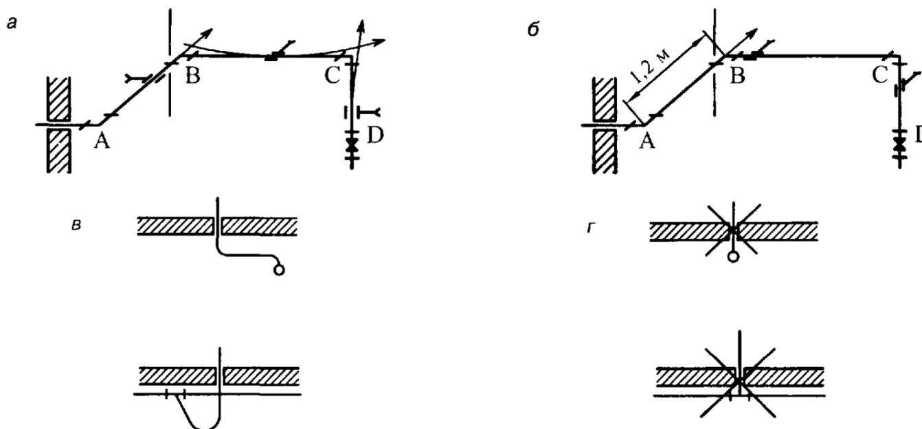
**Рисунок 7** — Прокладка газопроводов с соблюдением правил естественной компенсации
