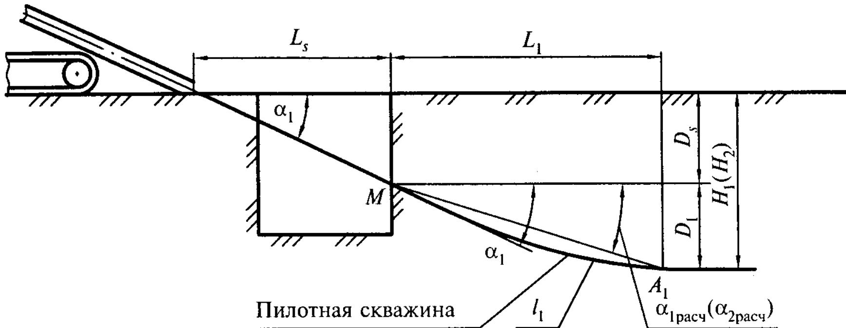
Рисунок Л.2 – Схема забуривания пилотной скважины
