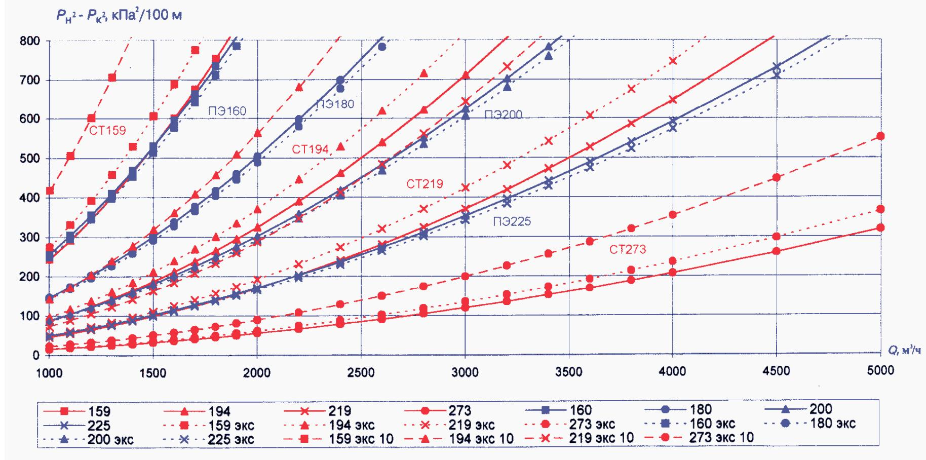
"Удельные потери давления для стальных и полиэтиленовых труб (новых и бывших в эксплуатации) среднего давления"
