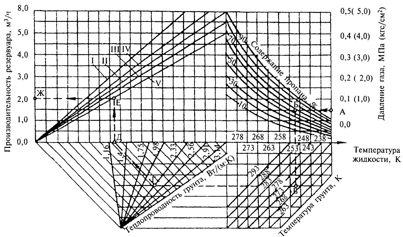
I — резервуар  $5 \text{ м}^3$ , заполнение 85 %; II — резервуар  $5 \text{ м}^3$ , заполнение 50 %; III — резервуар  $5 \text{ м}^3$ , заполнение 35 % и резервуар  $2,5 \text{ м}^3$ , заполнение 50 %; IV — резервуар  $2,5 \text{ м}^3$ , заполнение 85 %; V — резервуар  $2,5 \text{ м}^3$ , заполнение 35 %
