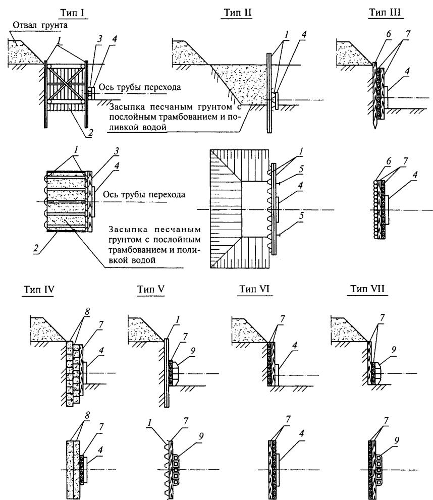
Тип I и II – для слабых грунтов ( $\phi \leq 18^\circ$ ); тип III и IV – для средних грунтов ( $\phi \leq 18-30^\circ$ ); тип V, VI и VII – для прочных грунтов ( $\phi > 30^\circ$ )
