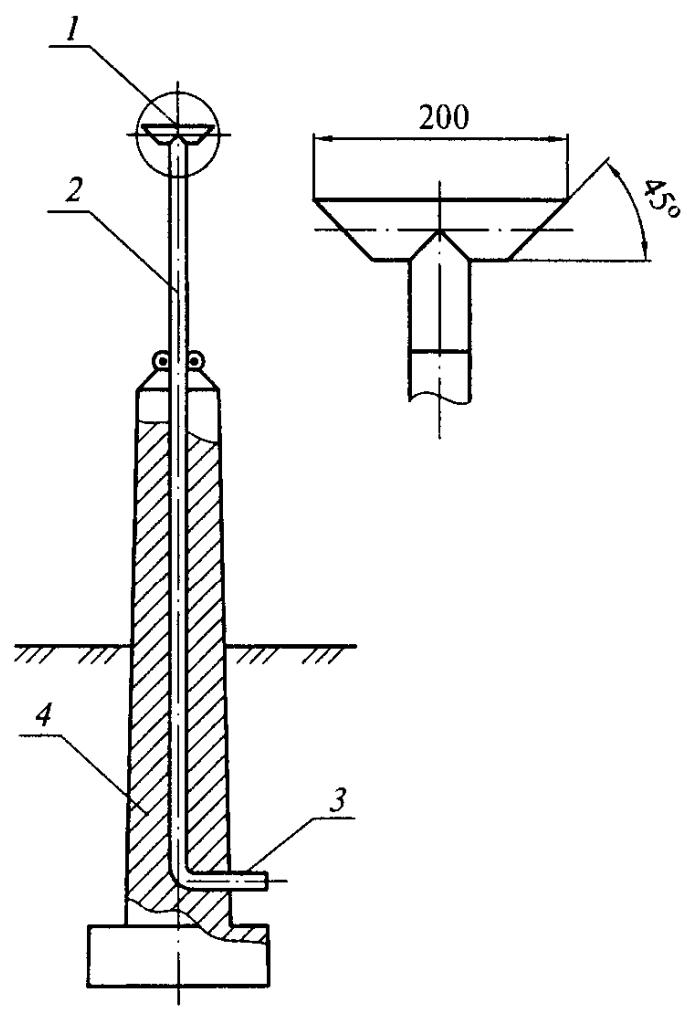
1 — оголовник; 2 — вытяжная труба, 3 — отводная труба;
