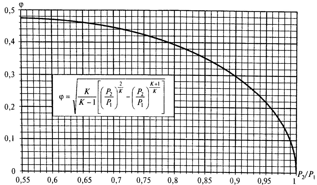
$$Q = 1595 f L P \phi i \text{ кв. корень } (1/po_0), \quad (18)$$
