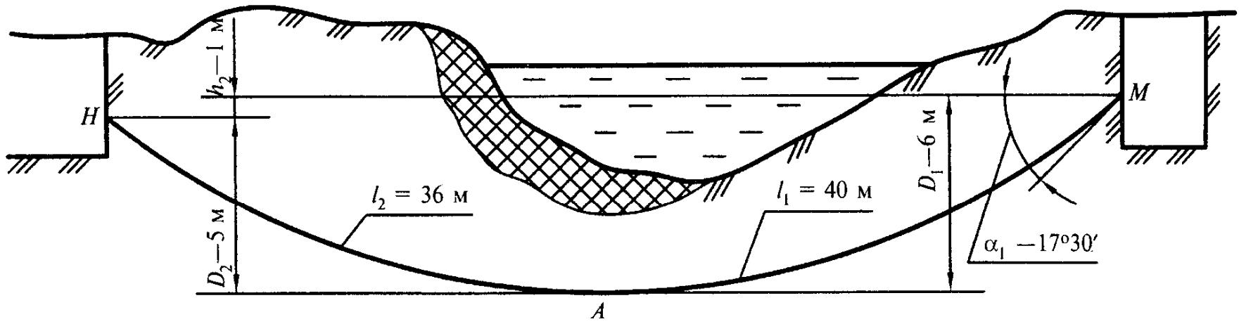
Рисунок Л.4 – Расчетные параметры пилотной скважины
