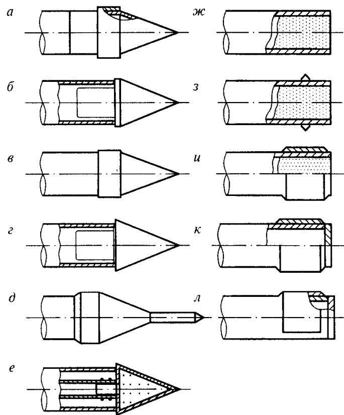
*а, б, в* — конусные наконечники; *г* — конусный наконечник с эксцентрикситетом; *д* — конусный наконечник с направляющей иглой; *е* — конусный наконечник с отверстиями для увлажнения грунта; *ж* — открытый конец футляра без наконечника; *з* — открытый конец кожуха с кольцом из круглой стали; *и* — кольцевой нож с наружным скосом режущих кромок; *к* — кольцевой нож с наружным скосом режущих кромок и приварной заглушкой; *л* — нож серпообразного сечения с приварной заглушкой
