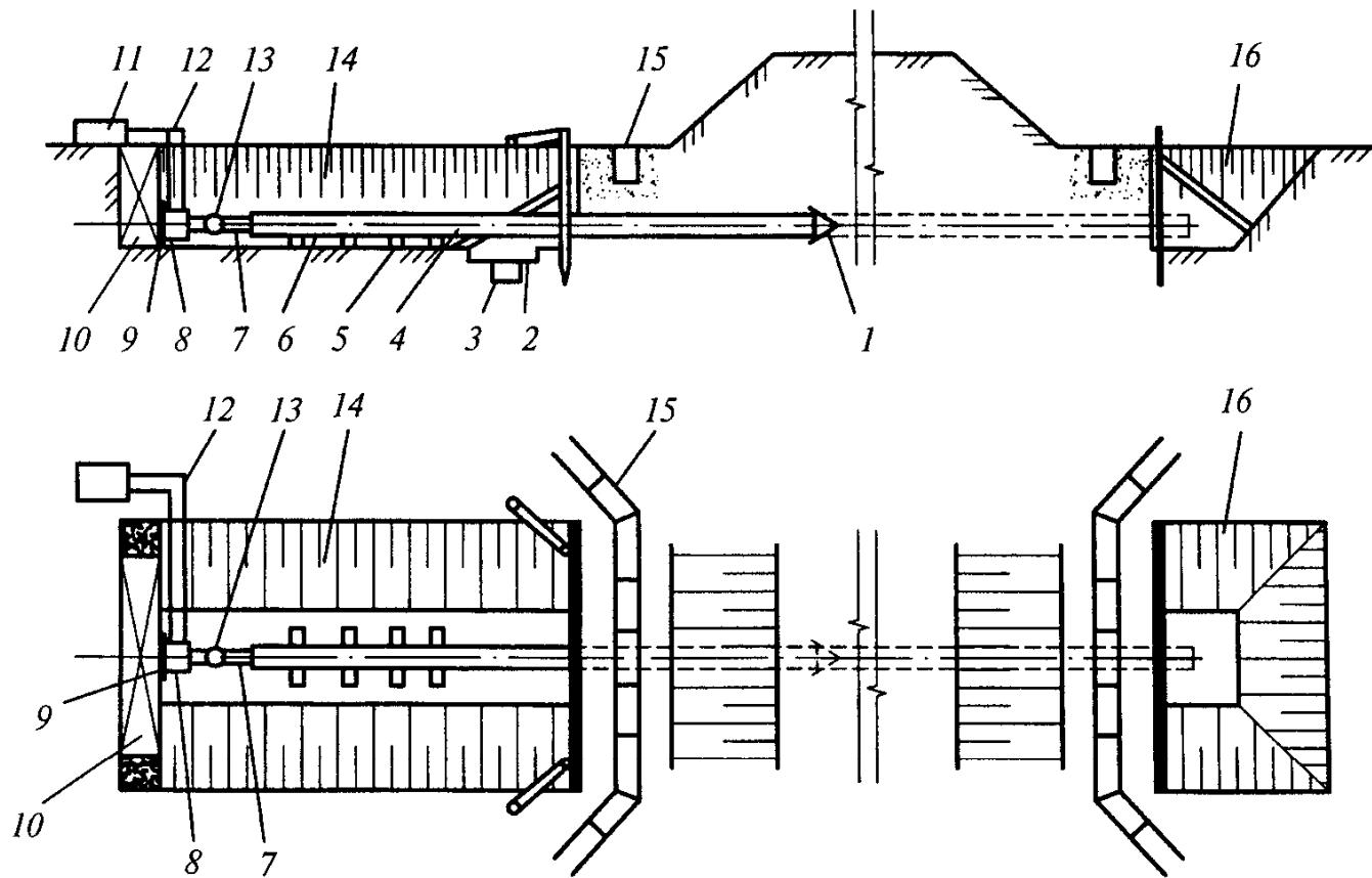
1 — конусный наконечник; 2 — прямок для сварки звеньев футляра в потолочном положении; 3 — прямок для стока грунтовых вод; 4 — труба-футляр; 5, 6 — направляющая рама; 7 — набор нажимных патрубков; 8 — гидродомкрат; 9 — опорный башмак; 10 — упорная стенка; 11 — насосная станция; 12 — трубы высокого давления; 13 — торцевая нажимная заглушка; 14 — рабочий котлован; 15 — водоотводной лоток; 16 — приемный котлован
