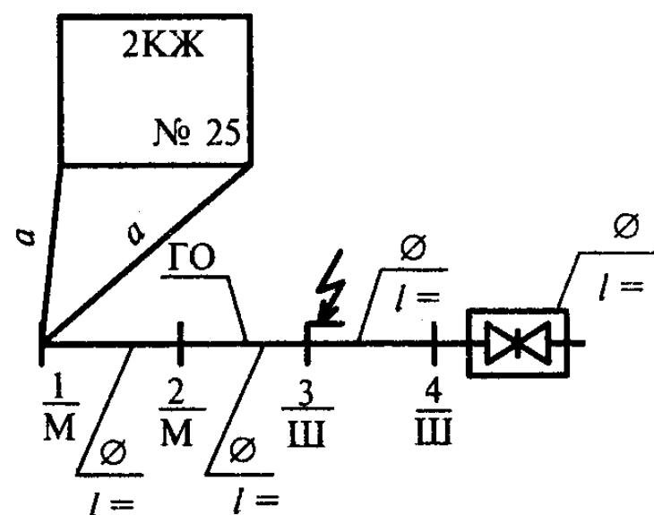
"Схема сварных стыков подземного газопровода-ввода"
