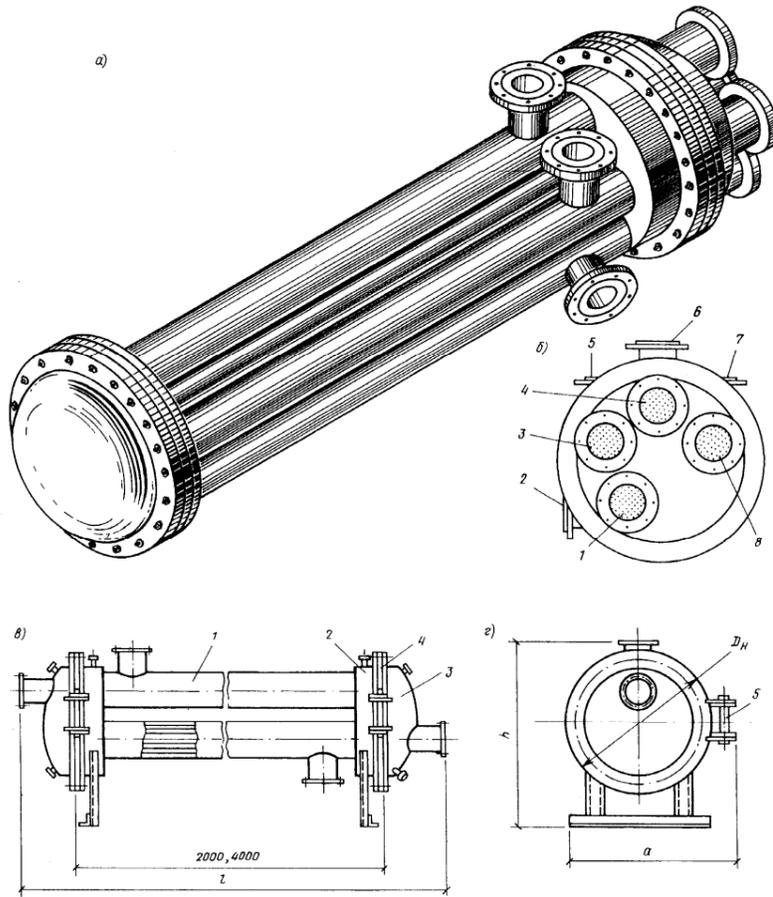
Рис. 5. Общий вид горизонтального многоходового кожухотрубного водоподогревателя
