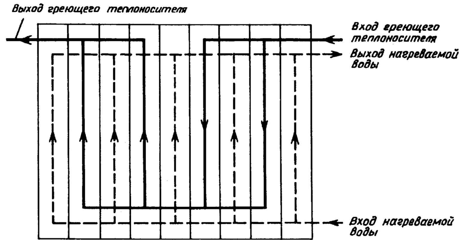
**Рис. 2. Несимметричная компоновка пластинчатого водоподогревателя, обозначение  $S_x (2 + 2)/5$**
