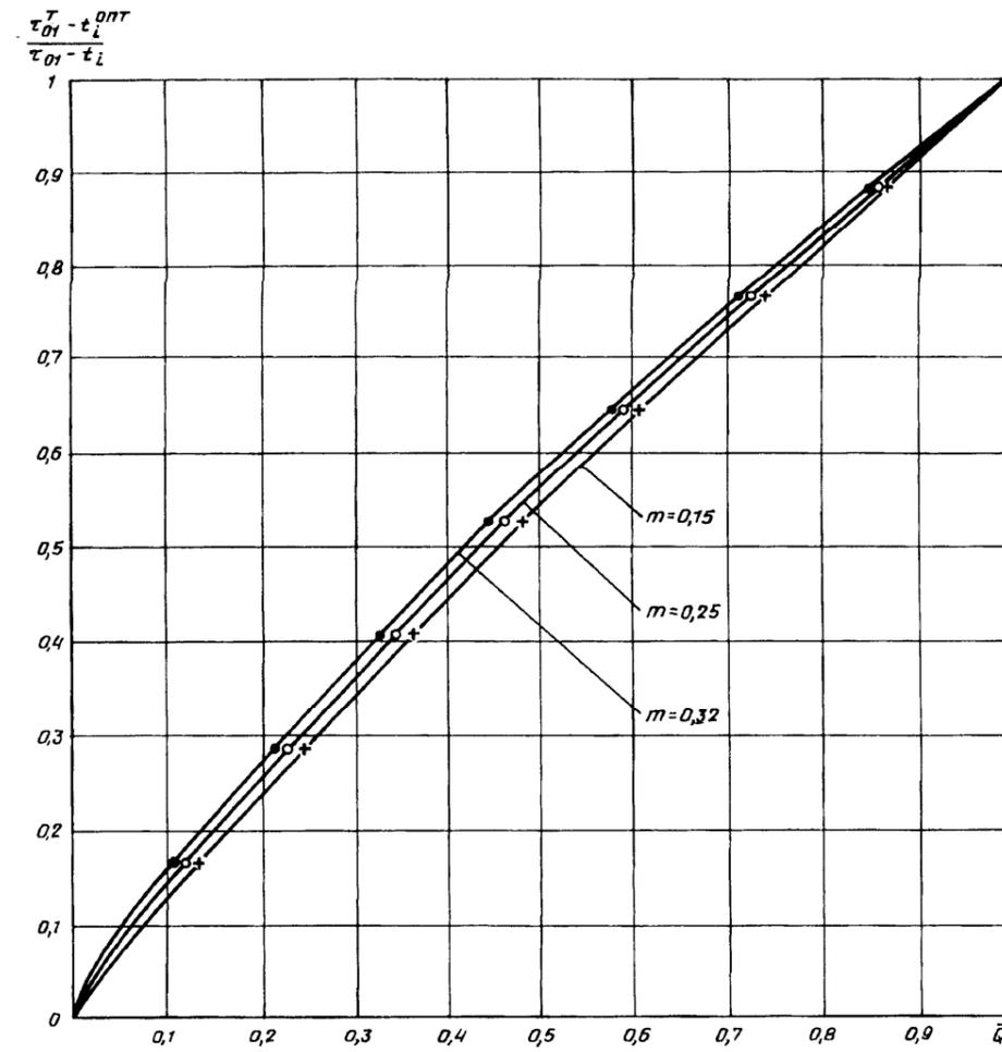
Рис. 2. Графики изменения температурного критерия системы отопления по температуре воды в подающем трубопроводе  $\frac{T_{01} - t_i^{opt}}{T_{01} - t_i}$  для различных значений показателя степени  $m$  и при постоянной циркуляции теплоносителя в системе
