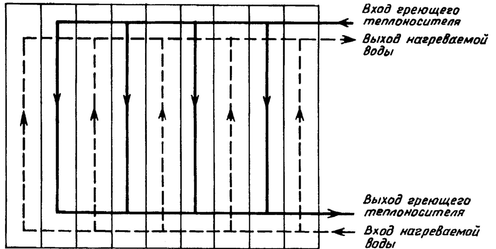
**Рис. 1. Симметричная компоновка пластинчатого водоподогревателя, обозначение Сх 4/5**
