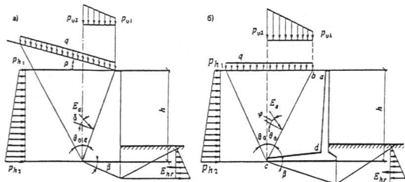
**2.17.** Наибольшее значение активного давления грунта при наличии на горизонтальной поверхности засыпки равномерно распределенной нагрузки  $q$  следует определять при расположении этой нагрузки в пределах всей призмы обрушения, если нагрузка ив имеет фиксированного положения.
