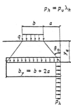
Черт. 2. Схема распределения давления от полосовой нагрузки
