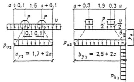
Черт. 4. Схема давления от автомобильной нагрузки АК при
