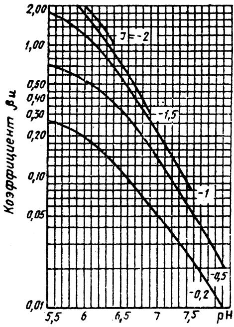
**Рис. 4. Номограмма для определения коэффициента  $\beta_i$  при расчете дозы щелочи**
