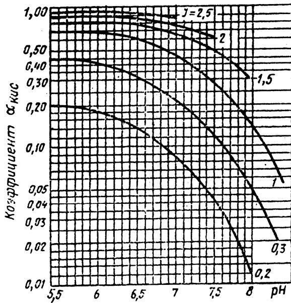
**Рис. 3. Номограмма для определения коэффициента  $\alpha_{\text{kис}}$  при расчете дозы кислоты**
