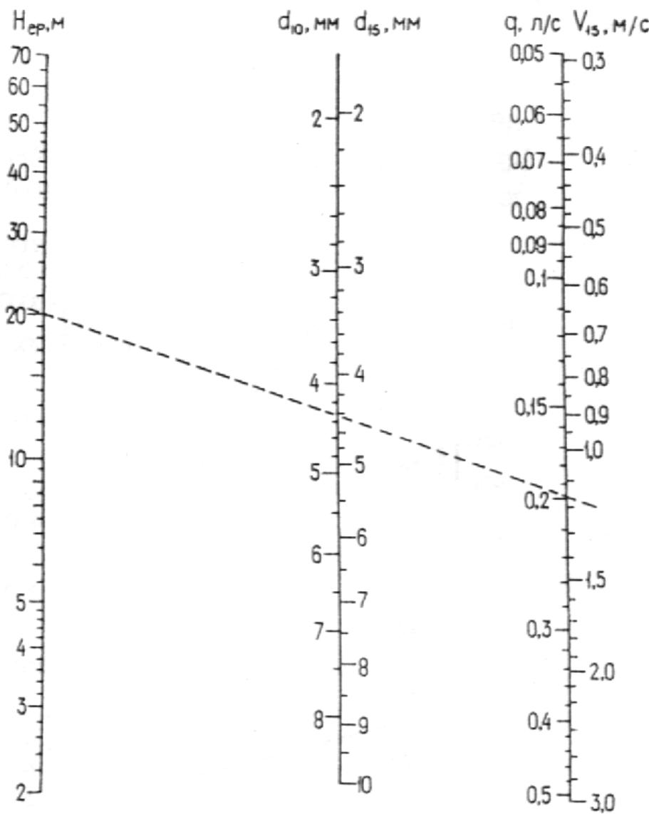
**Черт. 6. Номограмма для определения отверстий диафрагм, устанавливаемых у смесителей водоразборной арматуры санитарных приборов**
